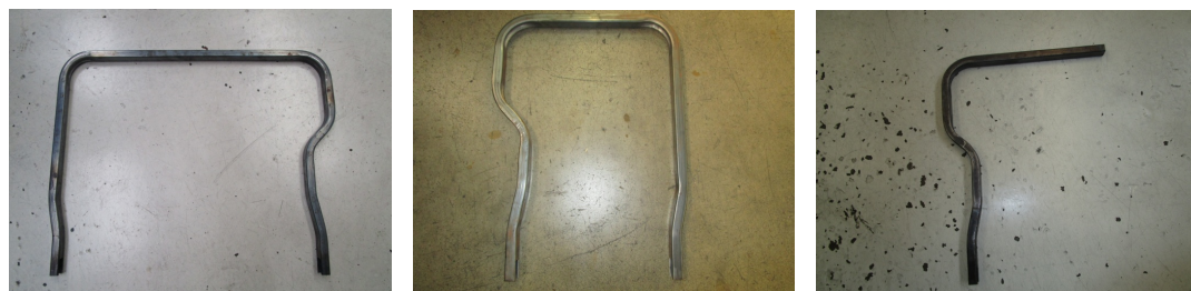
Esempi di prodotti finiti con piega e tranciatura
