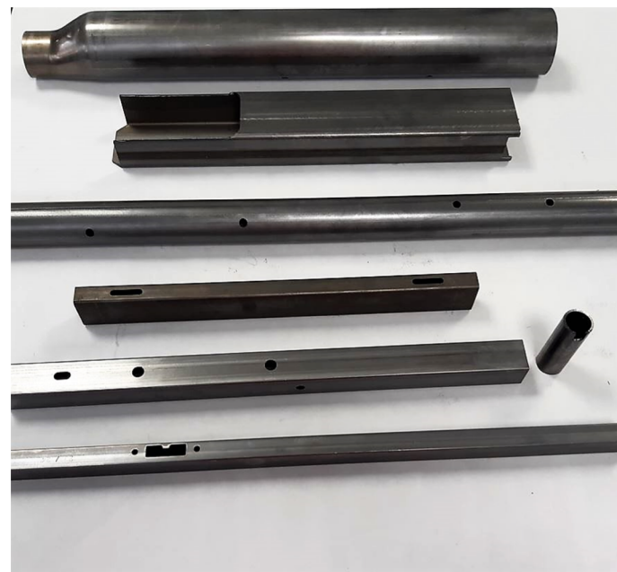
Esempi di prodotti finiti laserati e sagomati
